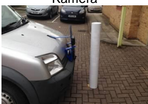
1 m langer Pfosten vor einer in 0,6 m Höhe montierten Kamera
