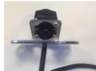
Um 180° auf Bügel gedrehte Kamera (die beiden längeren Schrauben entfernen, Kamera drehen und Schrauben wieder einsetzen)
